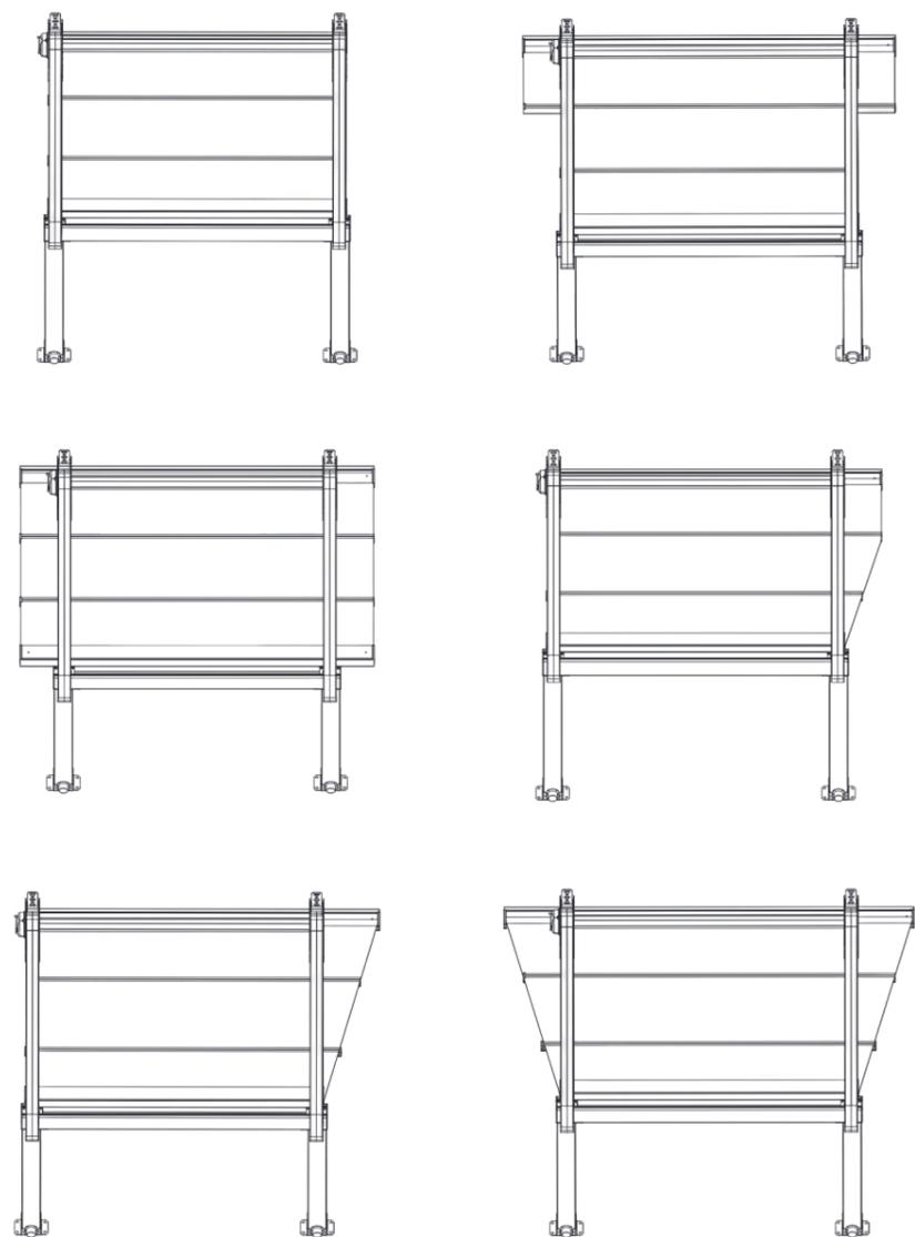
Das intelligente Profilsystem kann in unterschiedlichen Sonderformaten den IndustrieStoff aufnehmen. Sonderformen, Überstände in Rechteck oder Trapezform können so realisiert werden. Für ihre ganz speziellen Wünsche, fragen sie unseren Fachhändler
